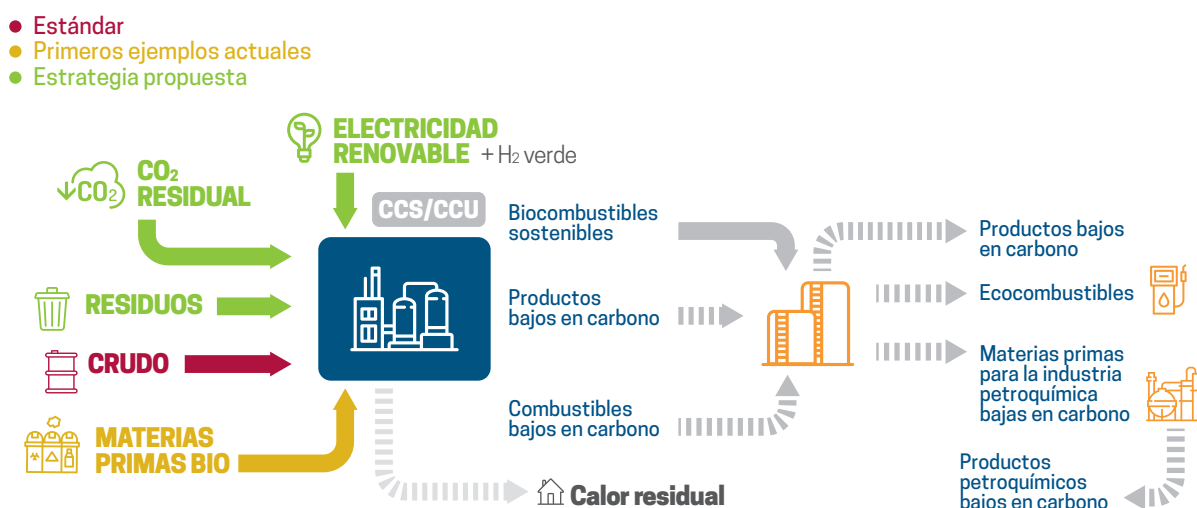
Figura 2: La refinería como centro energético dentro de “clusters” industriales
